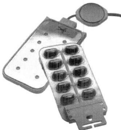
Le piastre per l'erogazione dello shock rilasciano gel conduttivo Blue prima di erogare lo shock.
