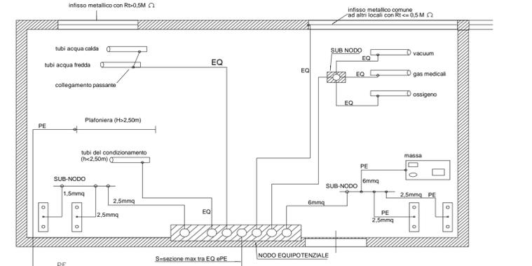
EQ=conduttore equipotenziale;  $S_{cu} > 6mm^2$ ,  $R$  (misurata)  $< 0,15 \Omega$ , connessioni comprese
